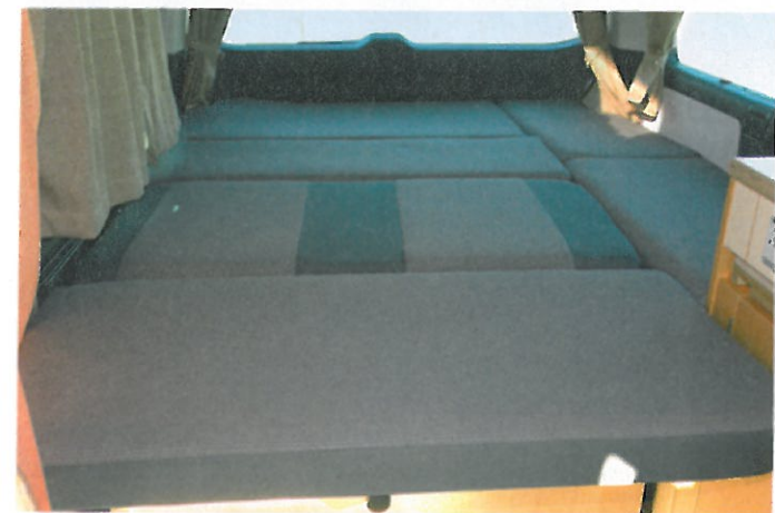
Trickreich: Da auf den Einbau eines Längsschranks zu Gunsten einer Stautruhe verzichtet wird, verbreitert sich die Liegefläche des Bettes auf 160 Zentimeter.
